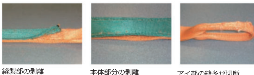
図 3-31 ベルトの剥離
