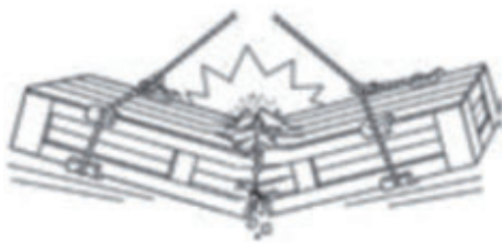
図 5-9 つり荷の破損
