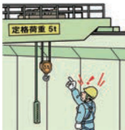
図 5-1 天井クレーンの定格荷重の表示例
