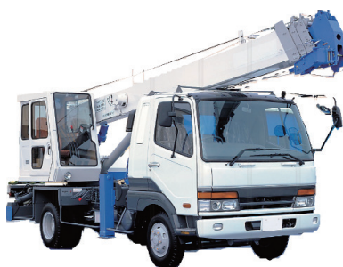
図1-7 トラッククレーン
