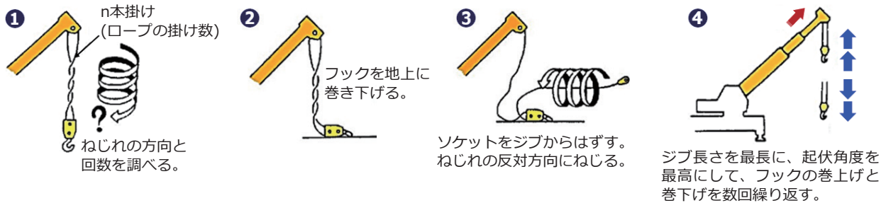
図1-90 巻上げ用ワイヤロープのねじれの取り方
