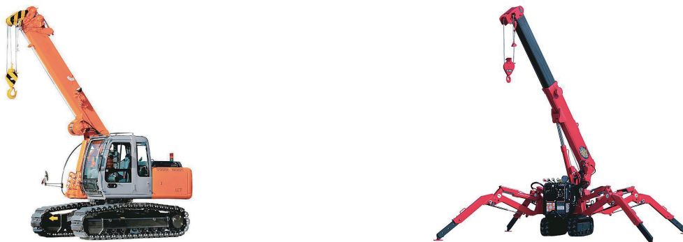
図1-11 小型クローラクレーン
