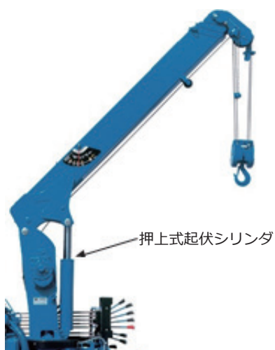
図1-40 油圧シリンダによる起伏装置
