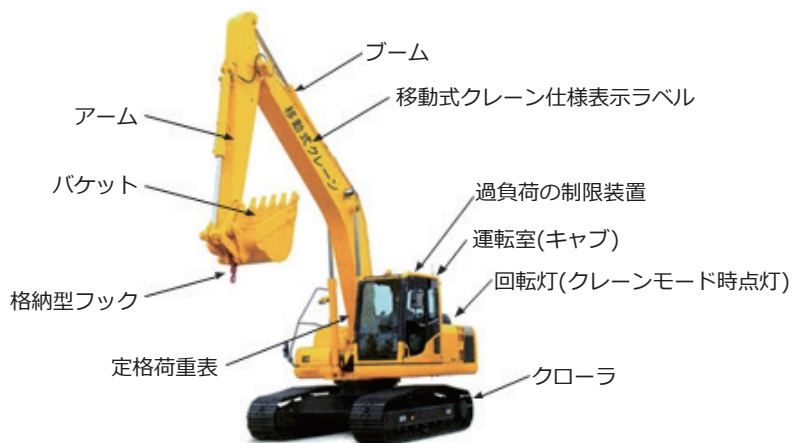
図1-14 クレーン機能付き油圧ショベル
