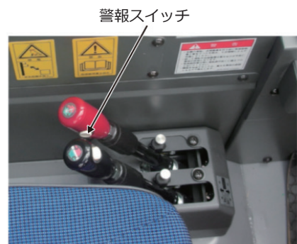
図1-55 ラフテレーンクレーンの警報装置(例)
