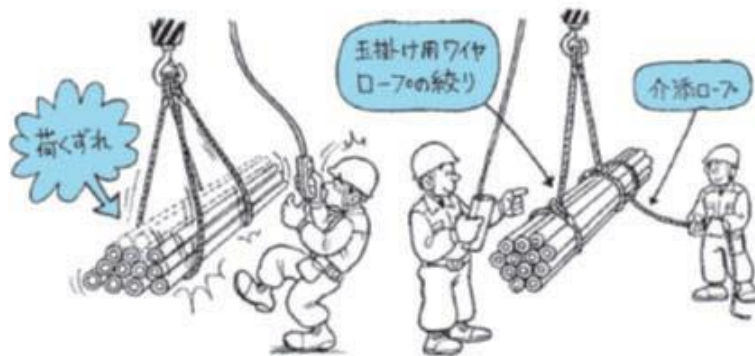
図 2-33 ロープの状況の確認
