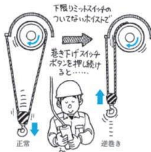
図 2-26 巻き上げ用ワイヤロープの逆巻き
